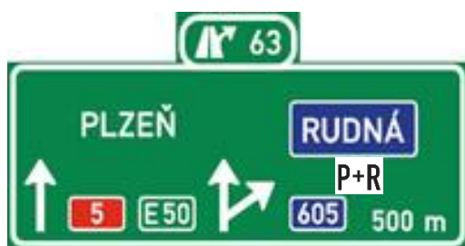
Obr. 32 Ukázka vizualizace dopravní značky IS 6b Návěst před křižovatkou s odbočkou na P+R
