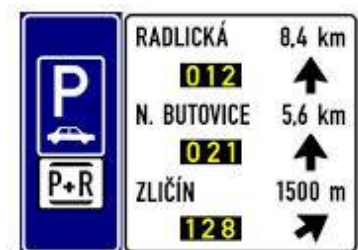
Obr. 36 Ukázka vizualizace dopravní značky dávající informaci o volné kapacitě P+R na více místech
