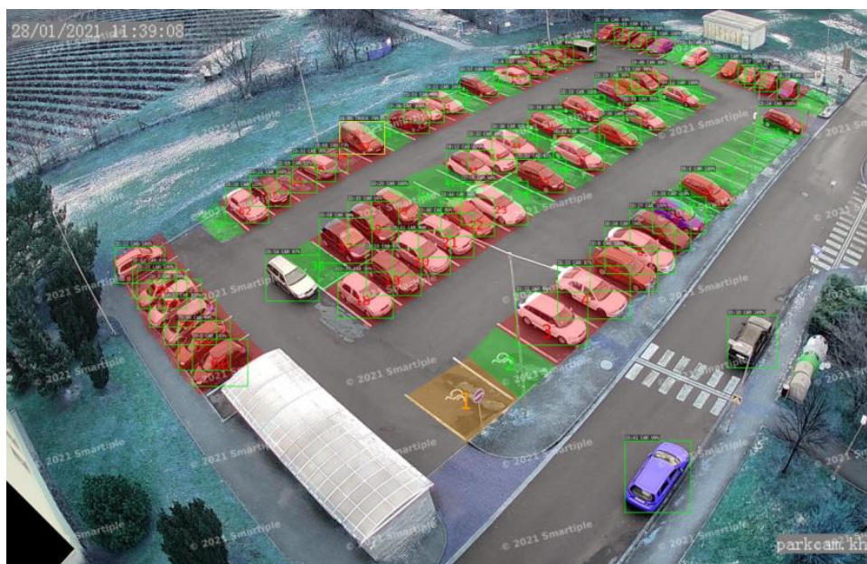
Obr. 31 Ukázka monitoringu obsazenosti na bázi chytrých kamer (Zdroj: www.smartiple.com )
